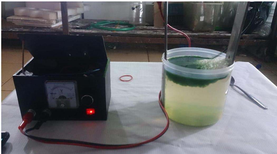
**Gambar 2.** Proses pemanenan *S. platensis* menggunakan metode elektrokoagulasi
