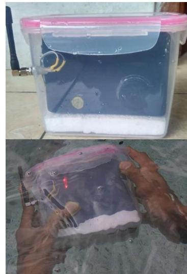
Gambar 15. Pengujian Box Waterproof
