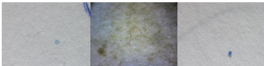
Gambar 2. Foto mikroplastik bentuk film (a), Bentuk fiber (b) & Bentuk fragmen (c)
