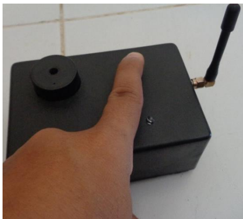
Gambar 17. Penekanan Button Pada Alat Pendeteksi Keberadaan Nelayan
